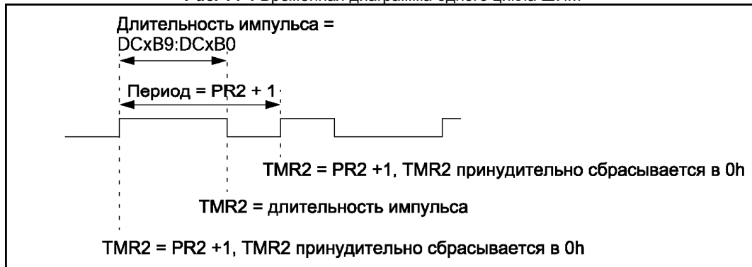
Рис. 14-4 Временная диаграмма одного цикла ШИМ
