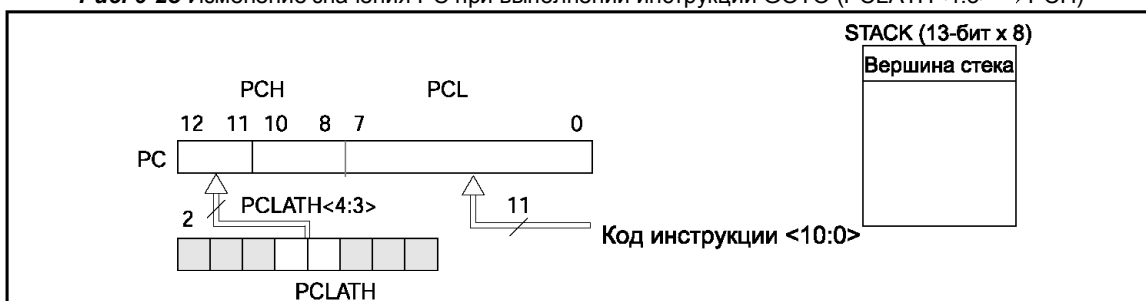
Рис. 6-2в Изменение значения PC при выполнении перехода к подпрограмме CALL (PCLATH<4:3> → PCH), при чем старое значение PC сохраняется в вершине стека
