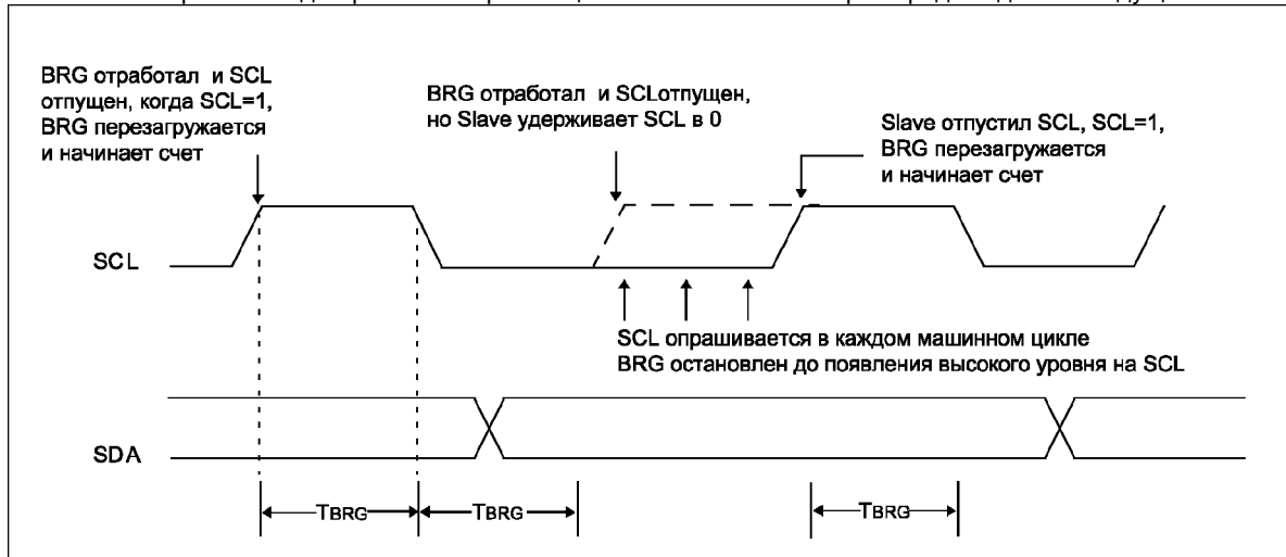
Рис. 17-33 Временная диаграмма синхронизации тактового сигнала при передаче данных ведущем шины
