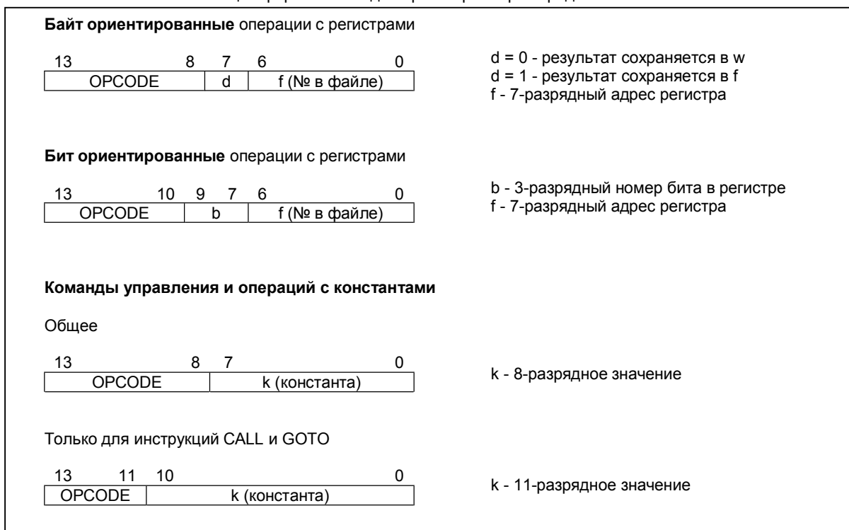
Рис. 29-1 Общий формат команд микроконтроллеров среднего семейства
