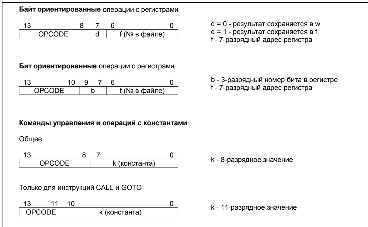
Рис. 5-1 Общий формат команд микроконтроллеров среднего семейства
