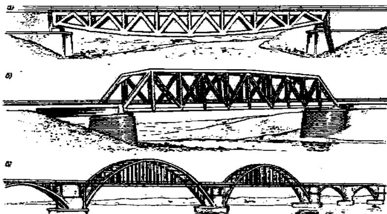
Рисунок 2.11 – Мосты с ездой: а – сверху; б – снизу; в – посередине
