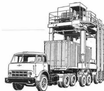
Рисунок 1.15 – Погрузчик-автоконтанеровоз
