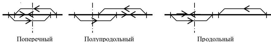
Рисунок 2.41 – Типы разъездов в осях
