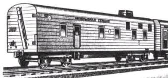
Рисунок 2.75 – Изотермический вагон
