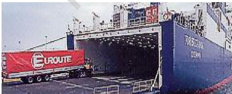
Рисунок 7.1 – Горизонтальная погрузка автомобильного транспортного средства на паром
