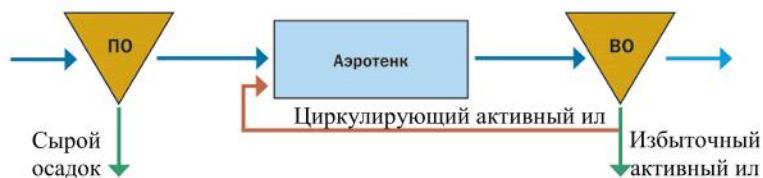
Рисунок 2.1 – Технологическая схема окисления органических соединений
