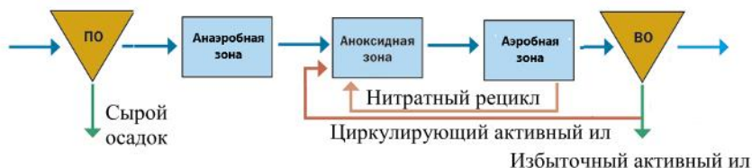
Рисунок 2.3 – Технологическая схема глубокого удаления азота и фосфора АА/О
