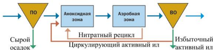
Рисунок 2.2 – Технологическая схема предварительной денитрификации
