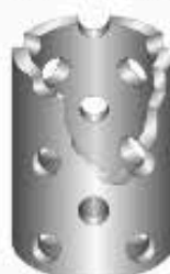
Рисунок 3.13 – Фильтры трубчатые стальные с круглыми отверстиями
