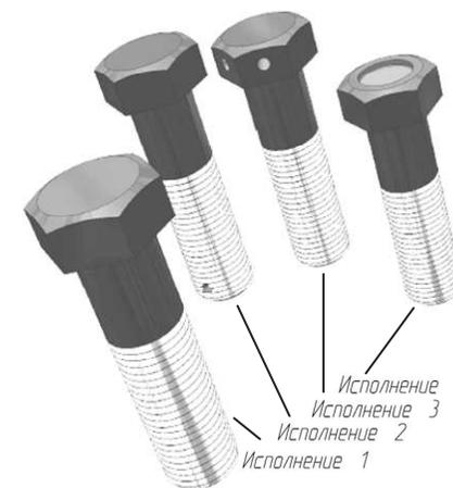
Рисунок 15 – Болты нормальной точности разных исполнений по ГОСТ 7798–70
