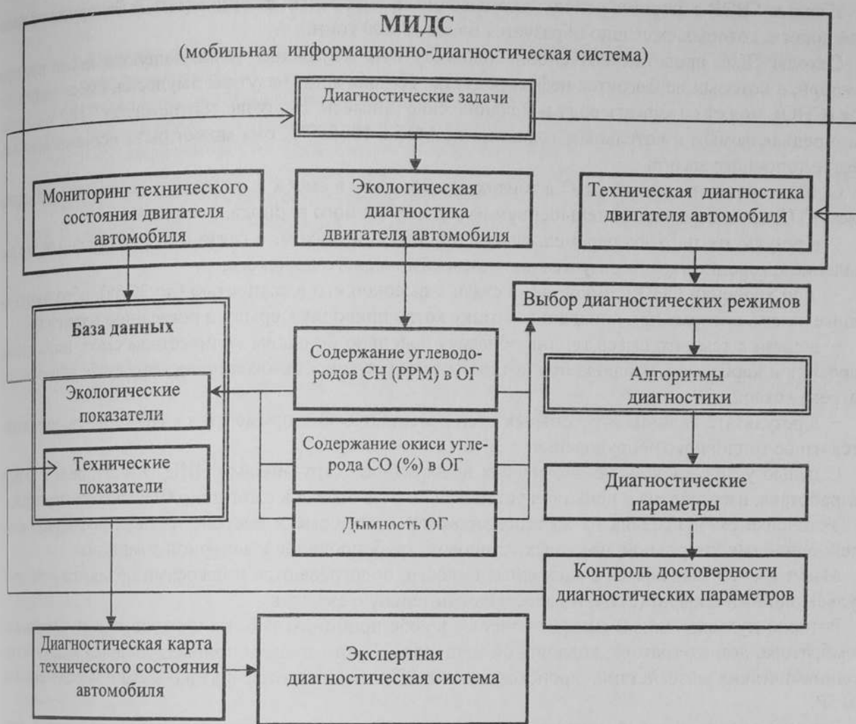
Рисунок 1 – Общая структурная схема мобильной информационно-диагностической системы диагностирования двигателей транспортных средств
