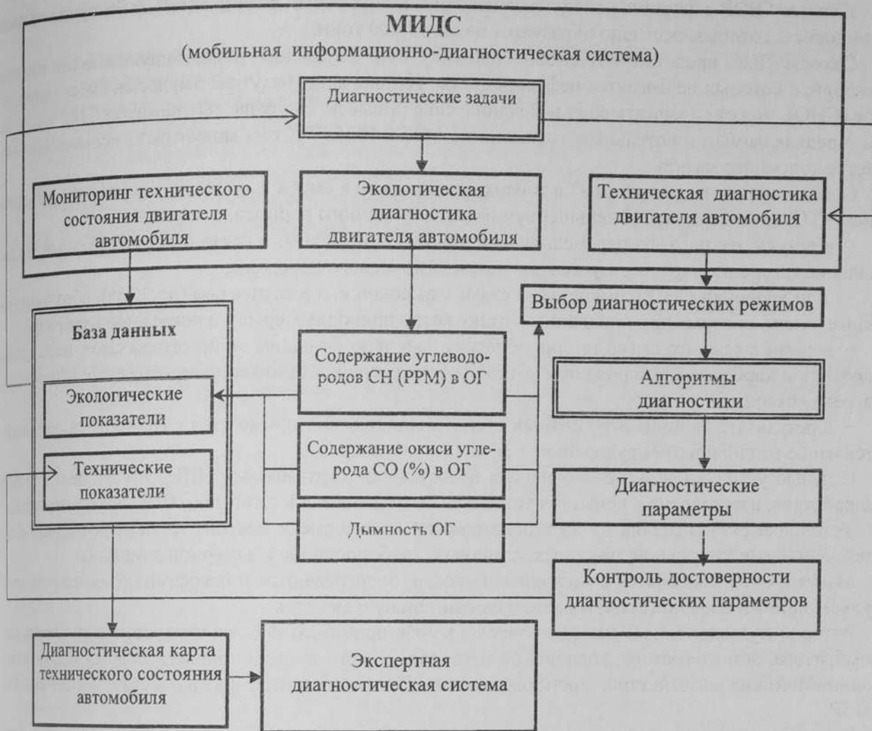
Рисунок 1 – Общая структурная схема мобильной информационно-диагностической системы диагностирования двигателей транспортных средств
