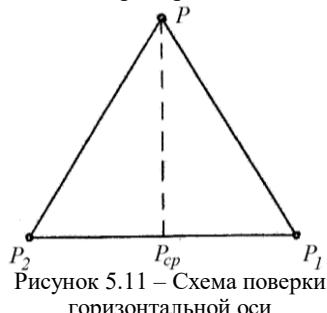
Рисунок 5.11 – Схема поверки горизонтальной оси
