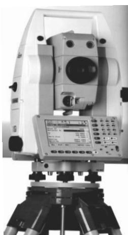
Рисунок 5.17 – Тахеометр
