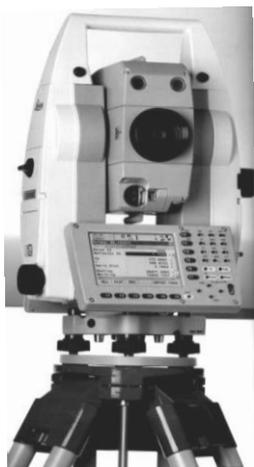
Такие измерительные приборы снабжены встроенными вычислительными и запоминающими устройствами, дающими возможность регистрировать и хранить результаты измерений, использовать их для дальнейшей обработки.
