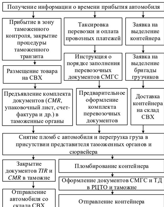
Рисунок 9.2 – Технологическая схема организации смешанной перевозки по варианту «автомобиль – контейнер»
