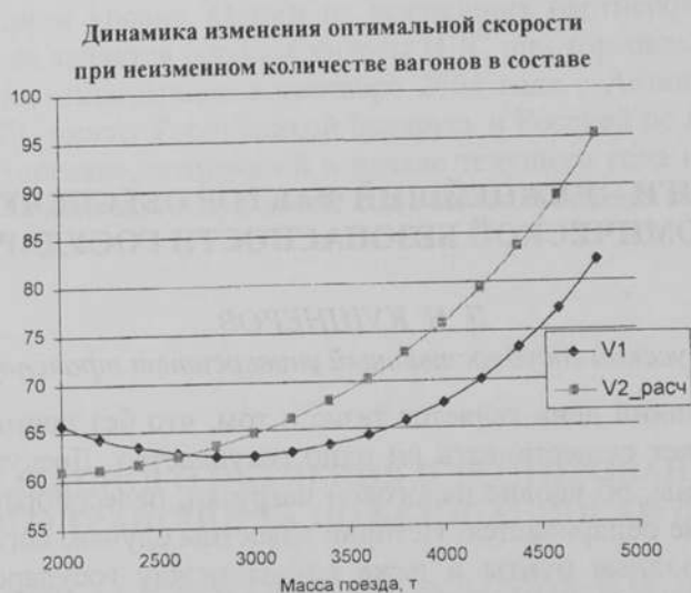
Рисунок 1 – Динамика изменения оптимальной скорости грузового поезда при неизменной осевой нагрузке (а) и неизменном количестве вагонов (б) в составе (кривая V1 – при среднедорожной ставке 1 поезд-часа, V2 – при расчетной ставке 1 поезд-часа)
