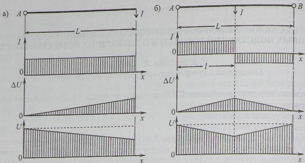
Рисунок 2 – Схема линий с сосредоточенной нагрузкой:
