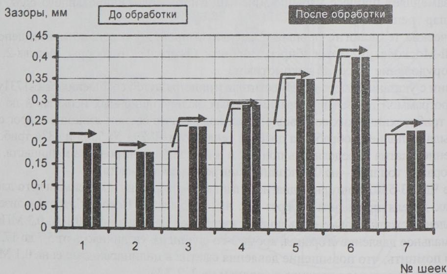
Рисунок 2 – Динамика изменения зазоров в коренных подшипниках коленчатого вала
