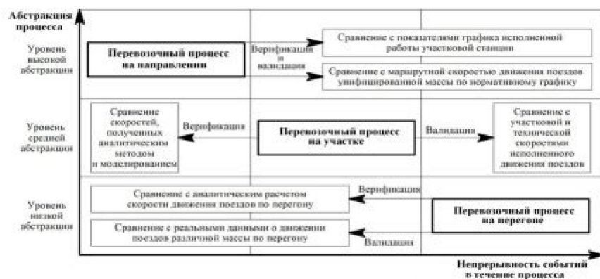
Рисунок 4 – Структура трехуровневой верификации и валидации
