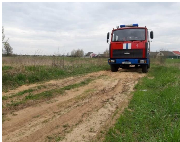
б – движение по грунтовой дороге категории VI-б с допустимой скоростью 20–30 км/ч, режим 2
