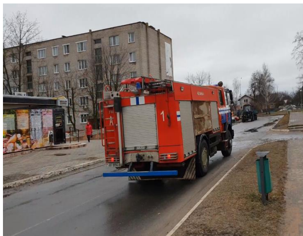
в – движение по прямому участку асфальтированной дороги со скоростью 50 \pm 2 км/ч с последующим замедлением до скорости 10–15 км/ч для вхождения в левый поворот на 90^\circ , режим 3
