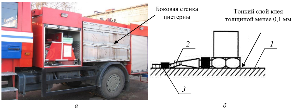
1 – поверхность конструкции; 2 – отсутствие натяжения кабеля; 3 – место фиксации кабеля на поверхности Рисунок 1. – Общий вид надстройки пожарного автомобиля на шасси МАЗ-5337 без фальш-панели цистерны (а), а также способ крепления датчика на стенку цистерны и фиксации кабеля (б)
