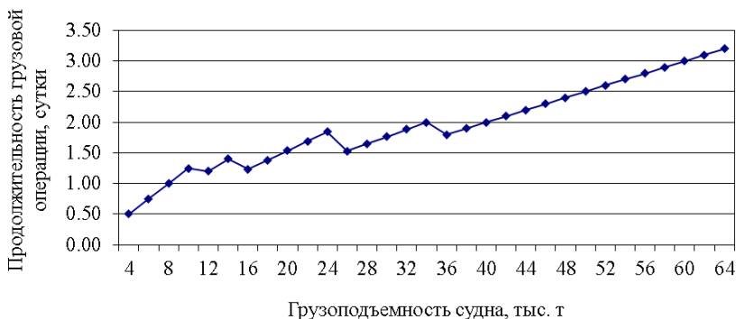
Рисунок 4.2 – График зависимости нормативной продолжительности грузовой операции от грузоподъемности судна (терминал KLASCO , порт Клайпеда)
