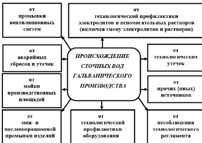
Рисунок 1 – Условия происхождения и формирования сточных вод гальванического производства
