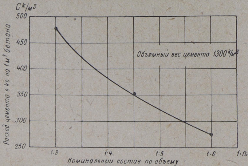
Фиг. 7. Зависимость расхода цемента на 1 м³ бетона от номин. состава.
