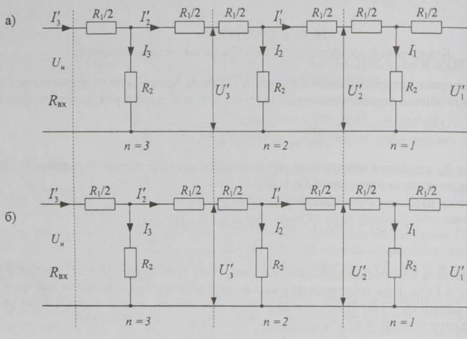
Рисунок 2 – Лестничная электрическая T-цепь:
