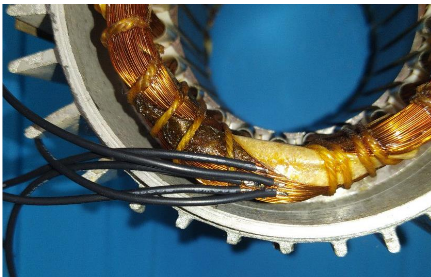
Рисунок 5 – Испытуемый статор асинхронного двигателя мощностью 0,12 кВт
