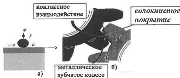
Рисунок 1 – Схема, моделирующая контакт зубьев с покрытием
