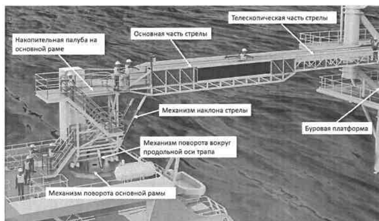
Рисунок 1 – Телескопический трап в штатном режиме работы
