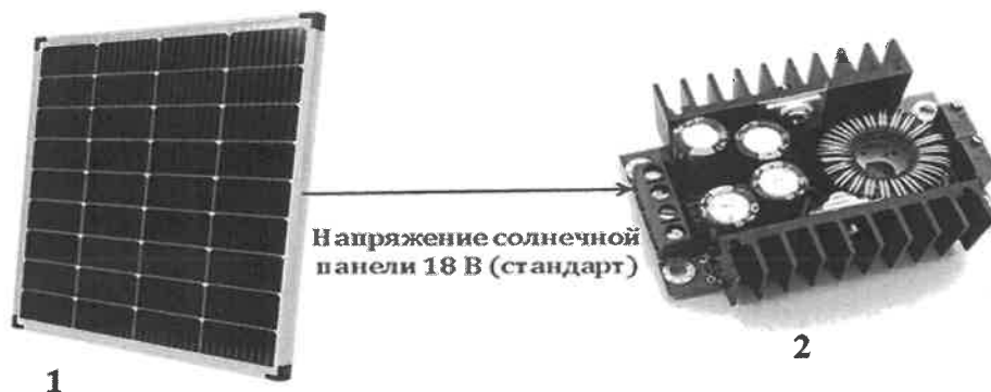
Рисунок 1 – Схема простого зарядного устройства: 1 – солнечная панель; 2 – DC-DC-преобразователь напряжения
