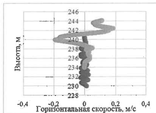
Рисунок 4 – Горизонтальные скорости лифта и противовеса (темно-серый цвет – лифт, светло-серый – противовес)
