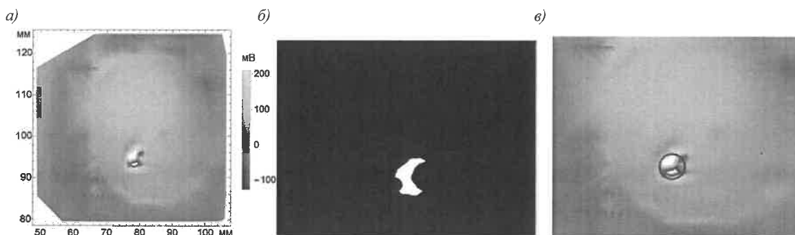
Рисунок 1 – Автоматическое обнаружение аномальных значений: а – исходное изображение; б – изображение, полученное пороговой бинаризацией и операцией закрытия; в – автоматически выделенная область интереса
