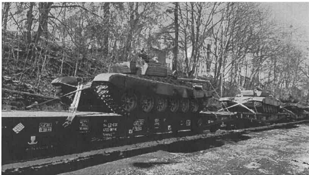
Рисунок 5 – Использование ремней при перевозке гусеничной техники
