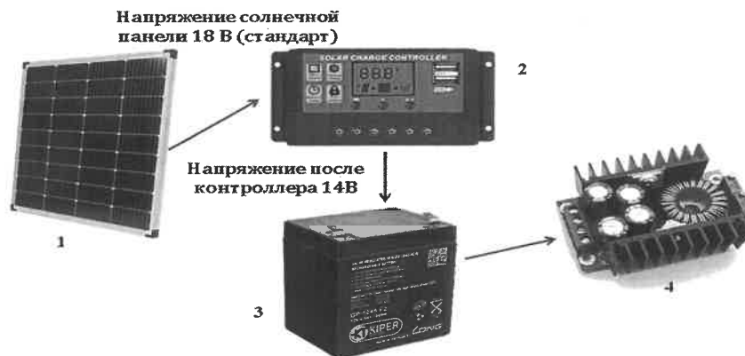
Рисунок 2 – Схема зарядного устройства с промежуточным накопителем:
