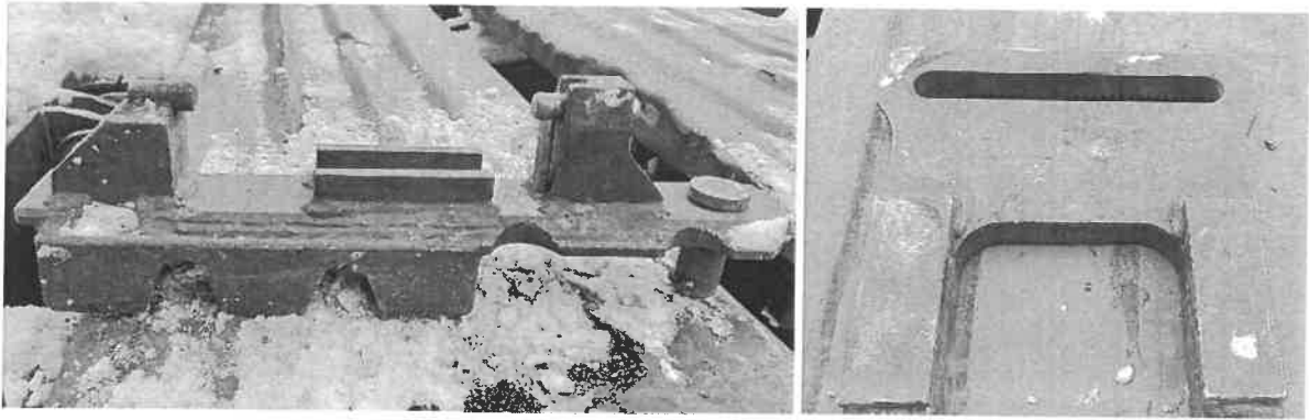
Рисунок 1 – Металлическая шпора Ш-188 и скоба С-188
