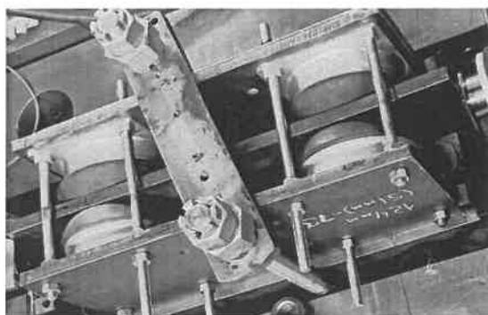
Рисунок 2 – Установка упоров горизонтальных на испытательной машине при ресурсных испытаниях
