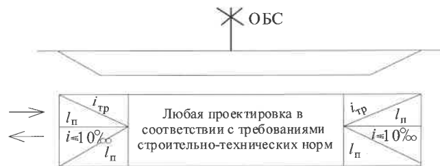
Рисунок 4 – Схема к проектированию продольного профиля на двухпутных вставках: i_{тр} – уклон, обеспечивающий трогание поезда с места; l_p – длина поезда
