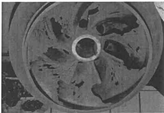
Рисунок 1 – Кавитационная эрозия: а – крыльчатки насоса; б – трубопровода
