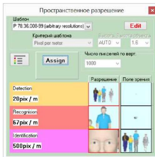
Рисунок 7 – Окно пространственного разрешения для камеры ActiveCam AC-D2053ZIR3
