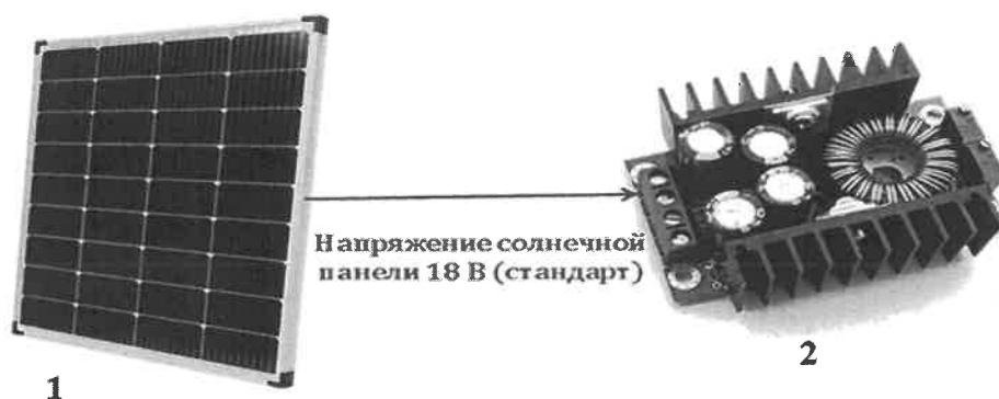
Рисунок 1 – Схема простого зарядного устройства: 1 – солнечная панель; 2 – DC-DC-преобразователь напряжения
