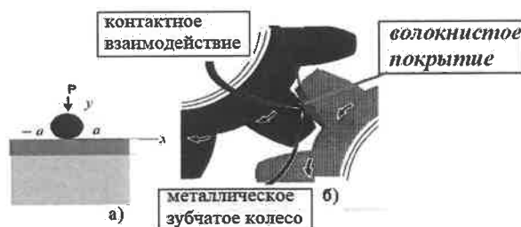
Рисунок 1 – Схема, моделирующая контакт зубьев с покрытием
