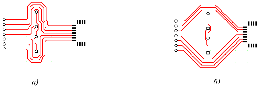
Рис. 9-39. Режимы прокладки проводников с максимальным прижатием а) и с минимальной длиной б)
