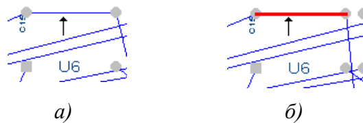
Рис. 10-25. Интерактивная трассировка отдельных соединений
