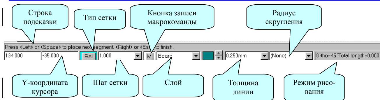
Рис. 9-7. Строка подсказки и строка состояния
