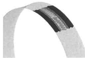
Рисунок 4 – Вид одной из полос износа, полученной в ходе численного моделирования
