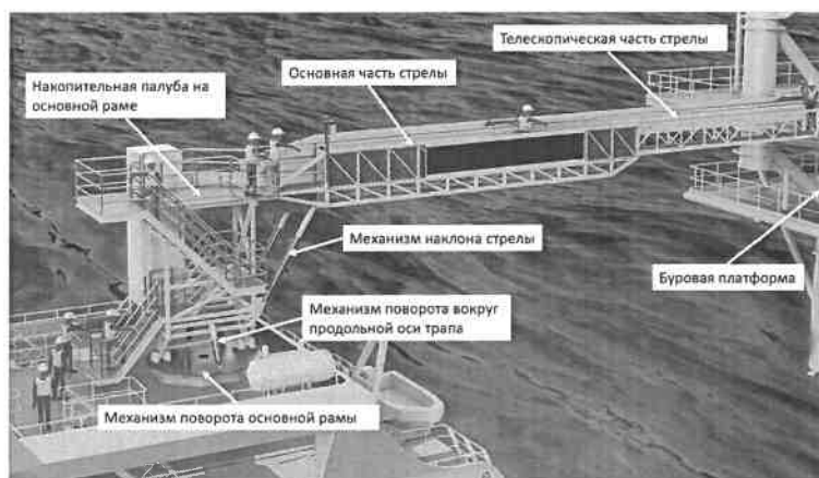
Рисунок 1 – Телескопический трап в штатном режиме работы
