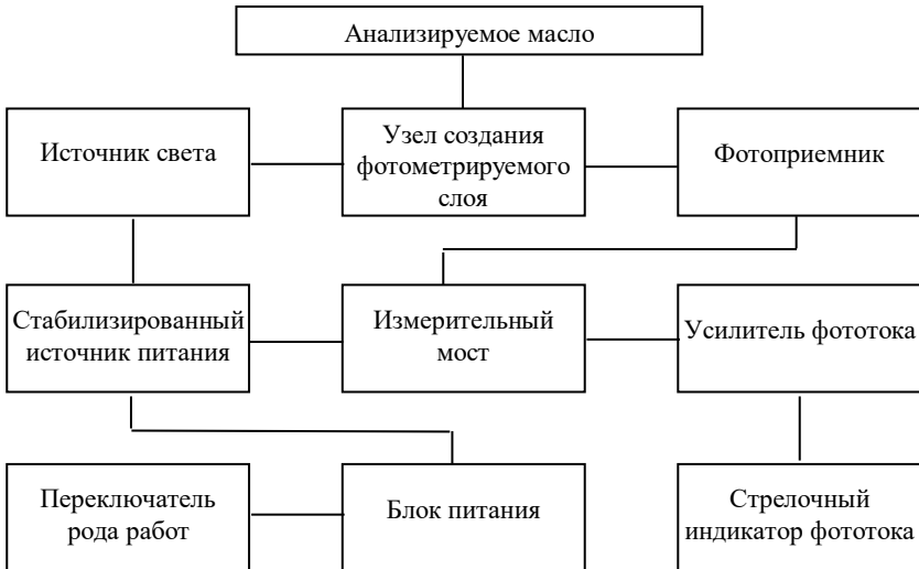
Рисунок 1 – Блок-схема прибора «Анализатор масла АМ-2к»
