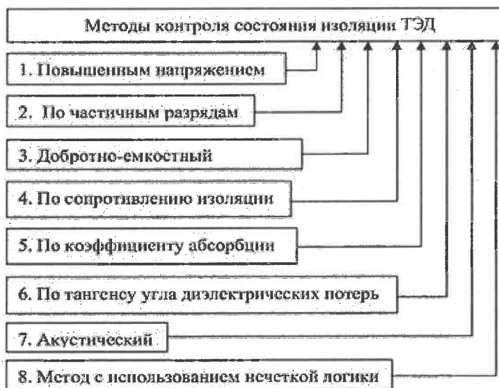
Рисунок 1 – Методы контроля изоляции ТЭД.
