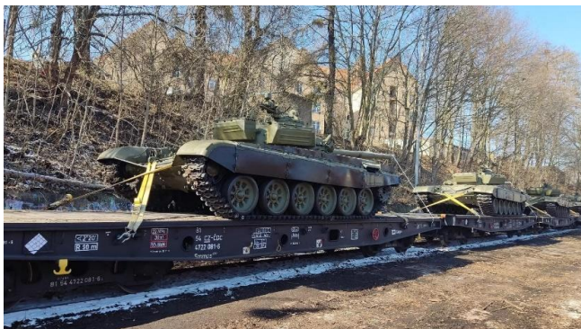
Рисунок 3 – Использование ремней при перевозке гусеничной техники
