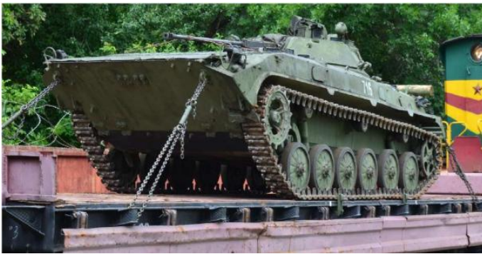
Рисунок 2 – Закрепление гусеничной техники при помощи комплекта УМК-СР
