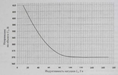
Рисунок 3 - Зависимость напряжения на нелинейном элементе от индуктивности в продольной цепи схемы защиты
