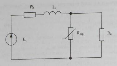
Рисунок 2 – Включение индуктивности в продольную ветвь схемы защиты
