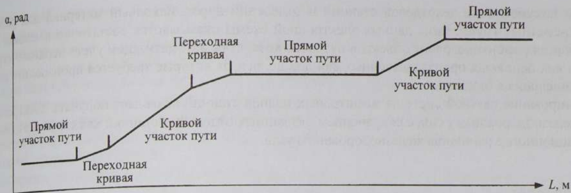
Рисунок 1 – Угловая диаграмма железнодорожного пути
