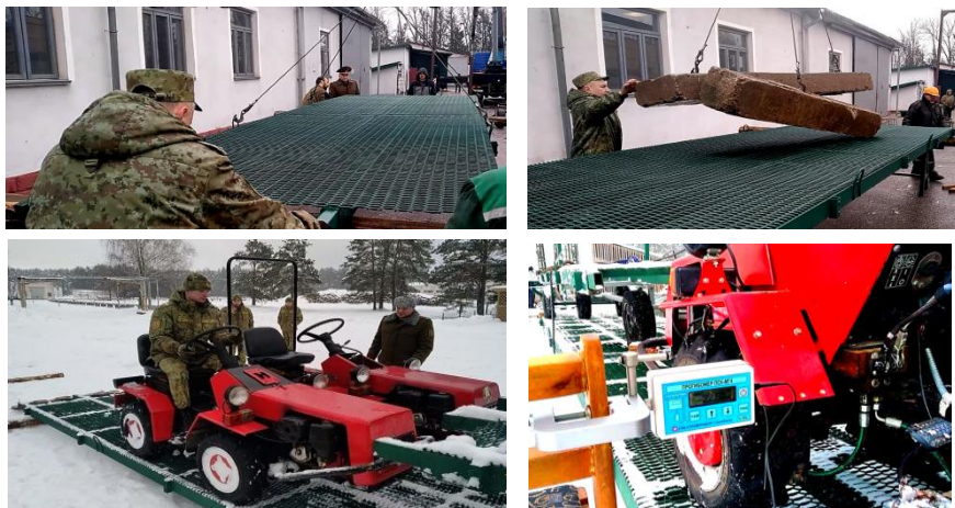
Рисунок 2 – Натурные испытания малогабаритных мостов в полевых условиях
