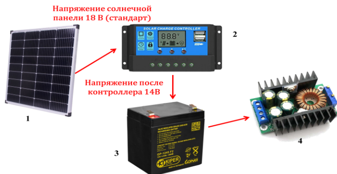
Рисунок 2 – Схема зарядного устройства с промежуточным накопителем: 1 – солнечная панель; 2 – контроллер солнечной панели; 3 – промежуточный накопитель; 4 – DC-DC преобразователь напряжения
