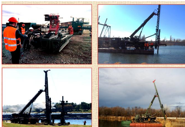
Рисунок 15 – Универсальный сваебойный агрегат УСА-2М
