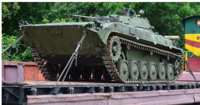
Рисунок 2 – Закрепление гусеничной техники при помощи комплекта УМК-СР
