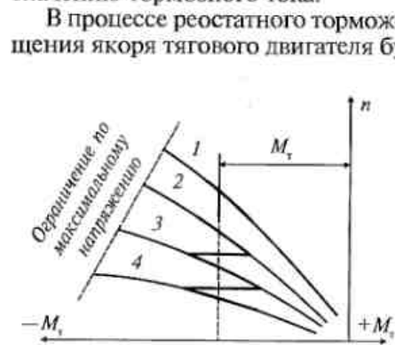
Рис. 53. Характеристики тягового двигателя, работающего в режиме реостатного торможения
