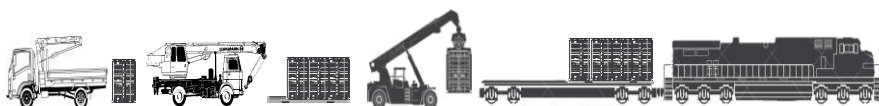
Рисунок 6 – Технологическая схема консолидации среднетоннажных модулей на контейнере-платформе с помощью автомобиля-самопозрузчика или автокрана и погрузка-выгрузка среднетоннажных модулей 20-футовым комплектом с помощью ричстакера
