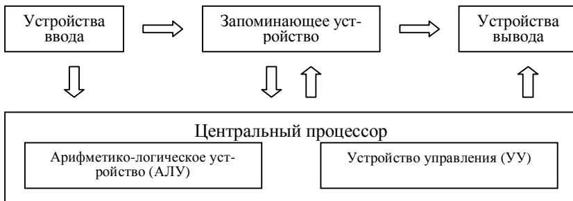
Рисунок 3.1 – Обобщённая структура компьютера
