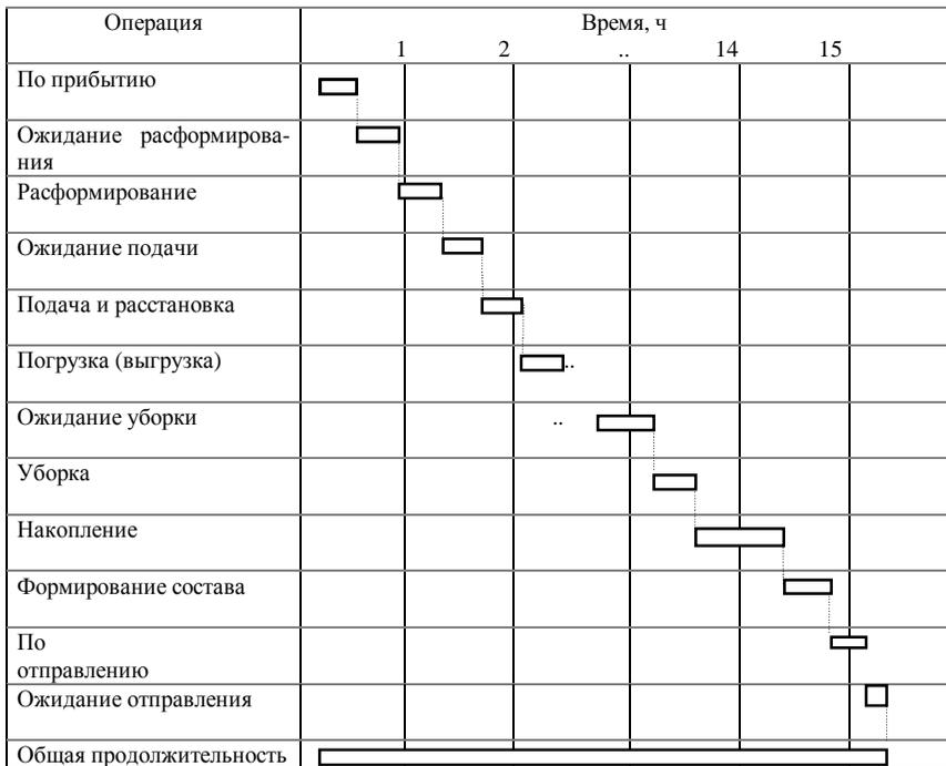
Рисунок 1.3 – Примерный график обработки вагонов на станции
