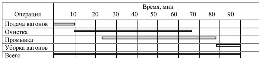
Рисунок 1.1 – Примерный график работы дезинфекционно-промывочной станции
