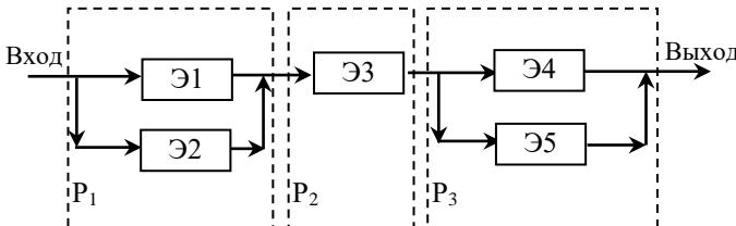
Рисунок 5.5 – Схема соединения элементов системы
