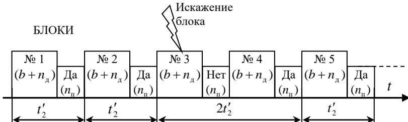
Рисунок 7.1 – Процесс передачи блоков данных
