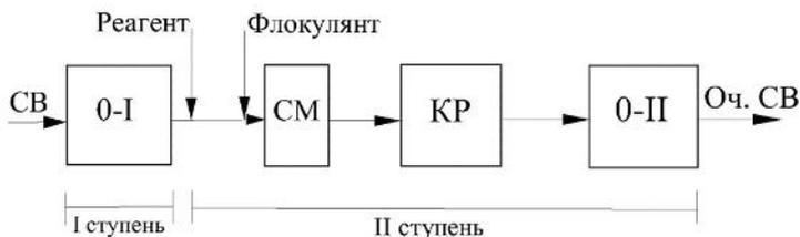
Рисунок 6.1 – Схема двухступенчатой очистки сточных вод:
