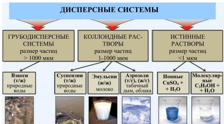
Рисунок 1.1 – Классификация дисперсных систем по признаку размер частиц
