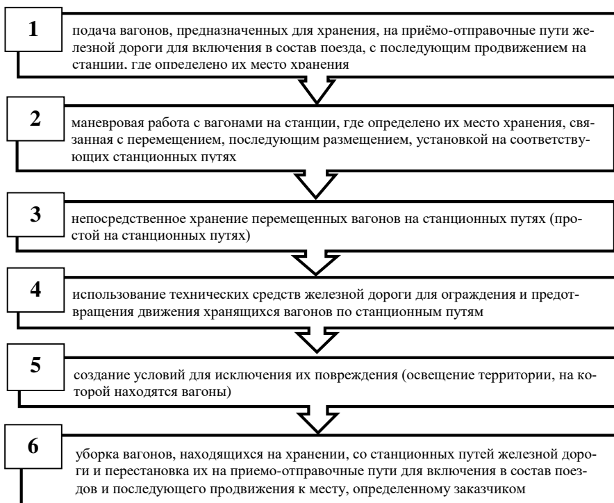
Рисунок 1 – Основные технологические операции при хранении новых вагонов на станционных путях
