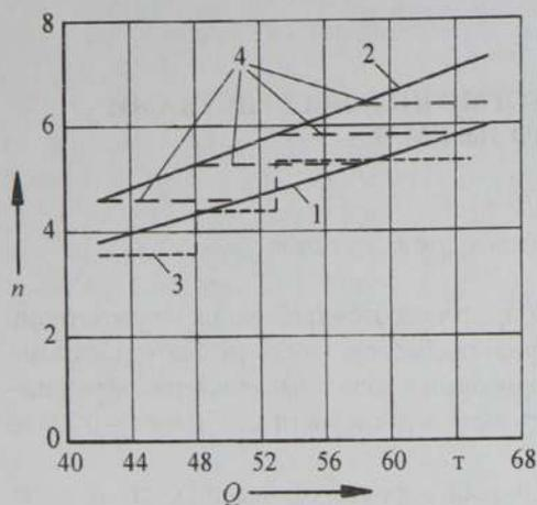
Рисунок 1 – Зависимость передаточного числа от массы вагона:
