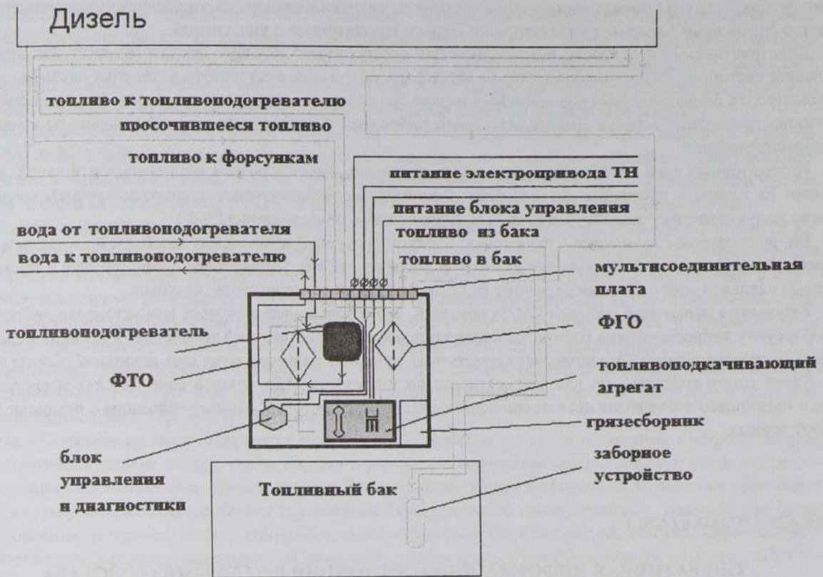
Рисунок 1 – Вариант модуля топливной системы
