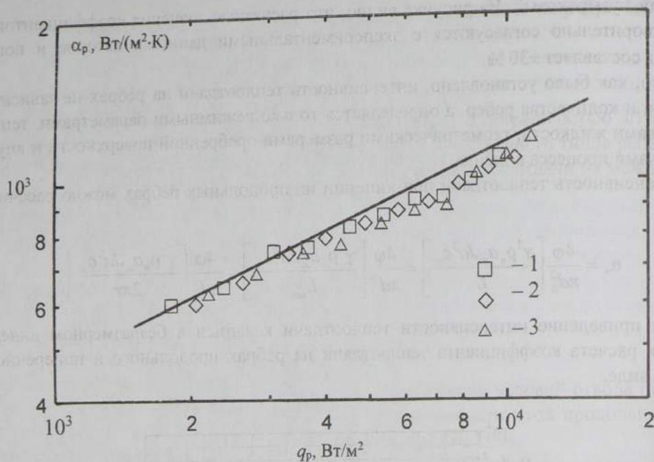
Рисунок 5 – Зависимость  $\alpha_p = f(q_p)$  для продольного оребрения : (ацетон); сплошная линия – расчет по уравнению; символы – экспериментальные значения; 1 – прямоугольный профиль; 2 – трапециевидный; 3 – треугольный
