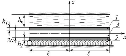
Рис. Трехслойная балка-полоска на нелинейно-упругом основании, взаимодействующая с пульсирующим слоем вязкой жидкости.
