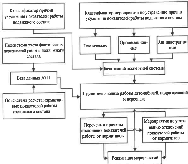
Рисунок 15.1 – Технология решения задач оперативного управления затратами с использованием экспертных систем
