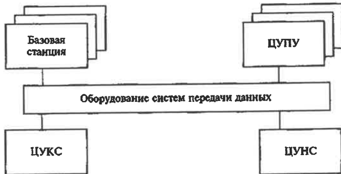
Рисунок 10.7 – Структурная схема взаимодействия элементов наземного сегмента спутниковой системы
