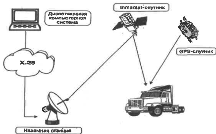
Рисунок 10.6 – Схема работы AVL-системы с использованием спутников Inmarsat
