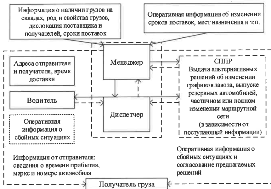
Рисунок 10.2 – Схема информационных потоков в системе доставки грузов
