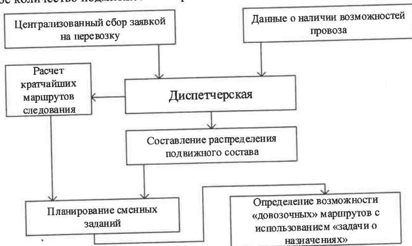
Рисунок 10.1 – Схема оперативного планирования перевозок
