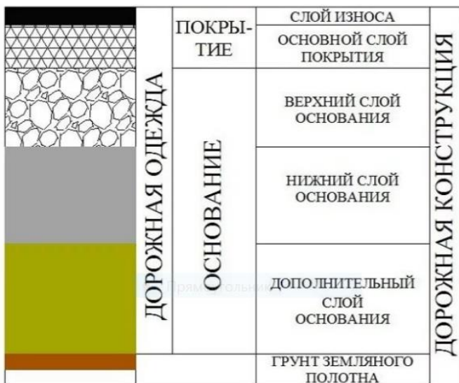
Рисунок 9.14 – Конструкция дорожной одежды с АБ покрытием
