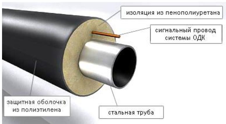
Рисунок 6.5 – Схема изолированного теплопровода (ПИ-трубы)
