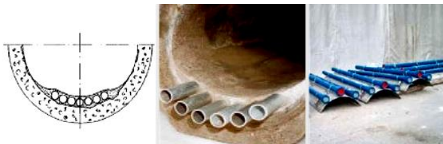
Рисунок 5.10 – Конструкции теплообменников, размещаемых в канализационных коллекторах
