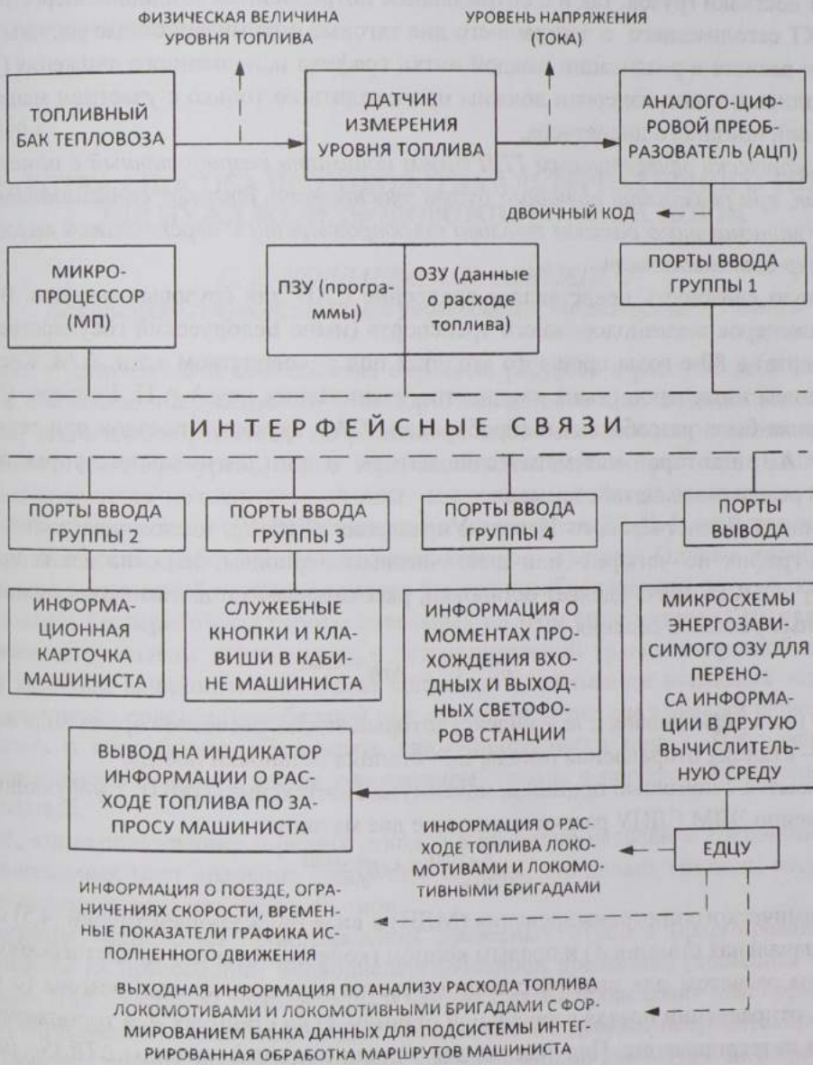
Рисунок 1 – Микропроцессорная система безбумажной технологии автоматизированного анализа потребления топлива магистральными локомотивами с выходом на интегрированную обработку маршрутов машиниста в АСУ реального времени
